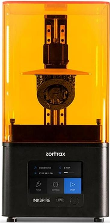
Première imprimante 3D de la marque, la Zortrax Inkspire utilise la technologie LCD UV. Chaque couche de résine est polymérisée, en une fois, par le rétroéclairage led de l'écran LCD haute résolution. Ce procédé allie une grande vitesse d'impression et une excellente résolution.
